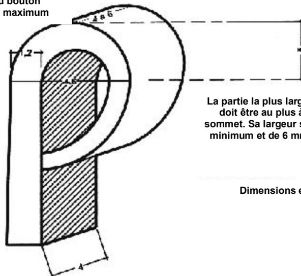
La partie la plus large du bouton doit être au plus à 3 mm du sommet. Sa largeur sera de 4 mm minimum et de 6 mm maximum
